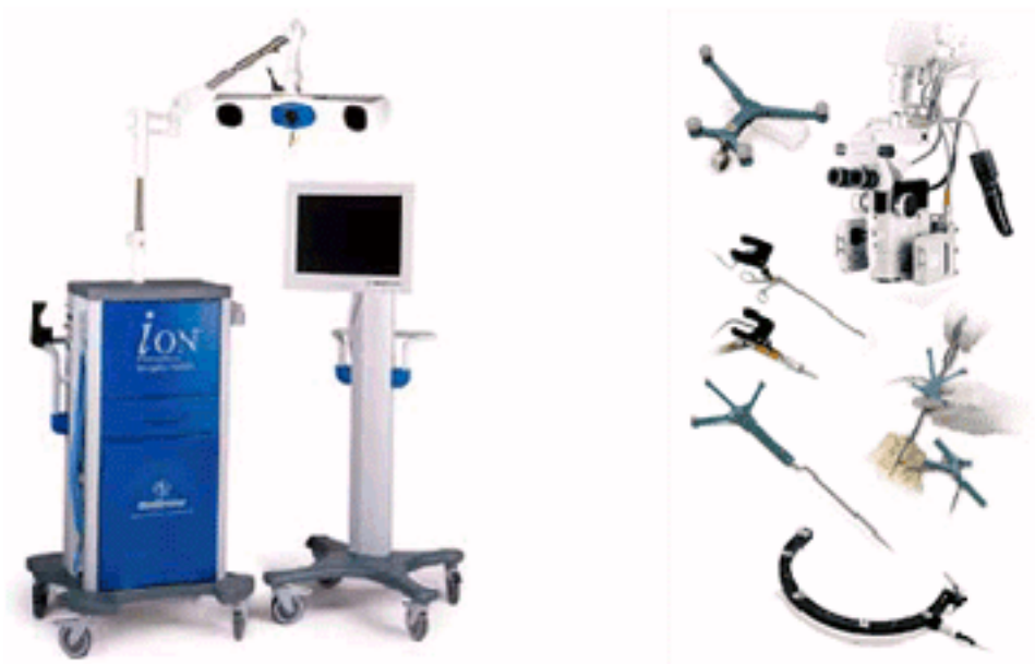
El navegador con su pantalla, Unidad de proceso y la cámara infrarroja. A la derecha, parte del instrumental con los faros (esferas) para diferentes usos en cirugía asistida por computadora.
