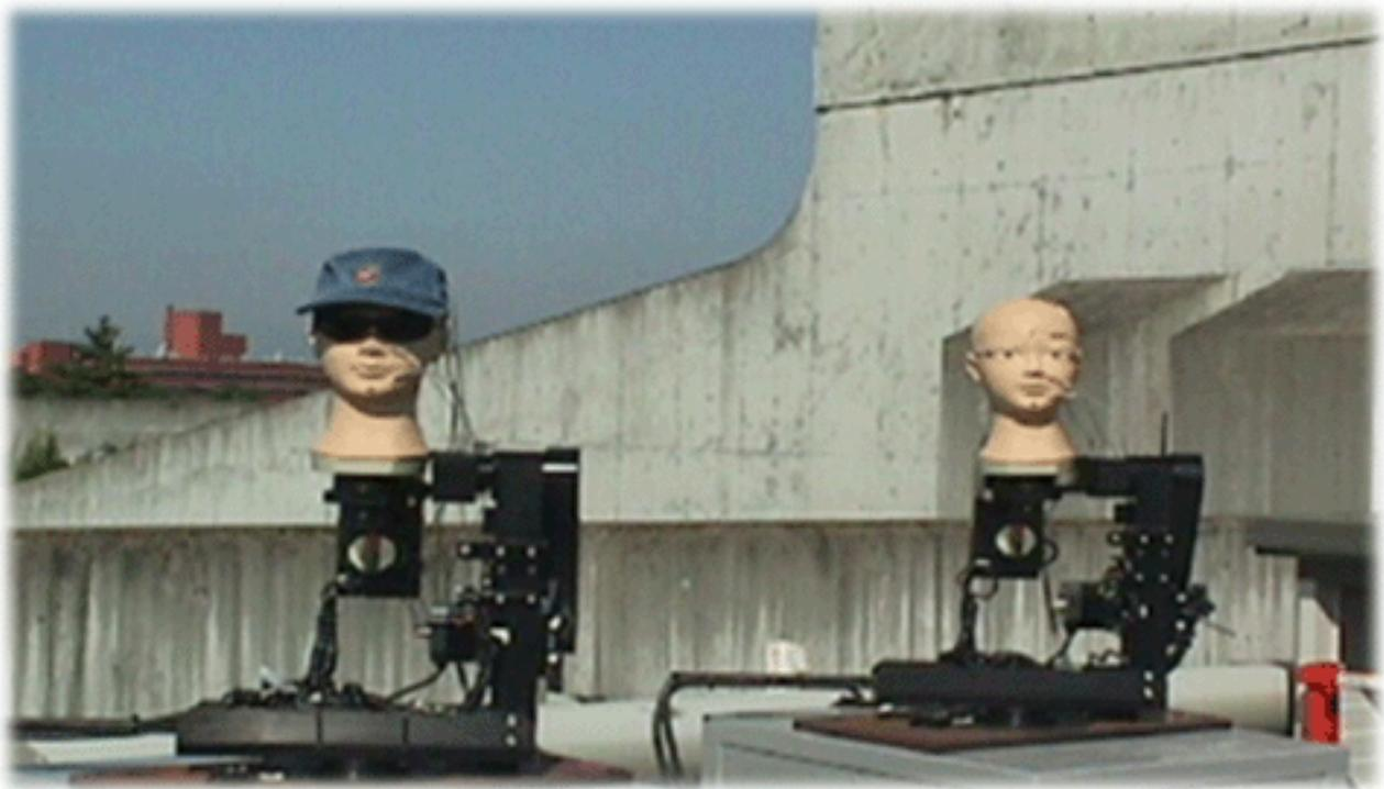
**Figura 2. Sistema utilizado para evaluar la exposición ocular a las UVR en el experimento del maniquí. (Cortesí del Prof. Masaji Ono, National Institute for Environmental Studies, Tsukuba, Japan)**
