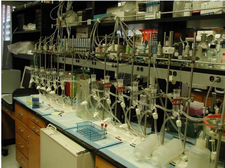
**Figura 5.-** Aparato de bioensayo en cascada acoplado a un sistema de adquisición de datos computarizado
